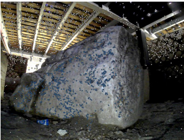
Fig. 7. Procedura SFM in luogo inaccessibile: fotogramma della fase di elaborazione e nuvola di punti.
