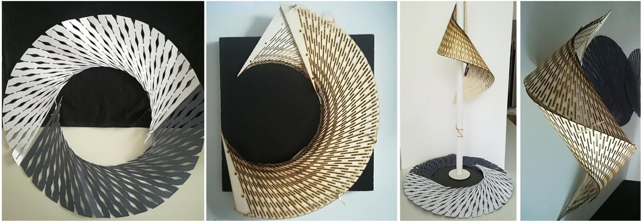
Fig. 13. Sperimentazione per la fabbricazione di un paraboloide iperbolico: esperimenti di kerfing e bending.
