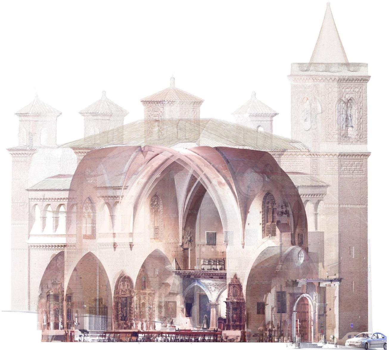
Fig. 9. Vista seccionada por el arco de la bóveda de crucería del modelo digital. Elaboración propia.
