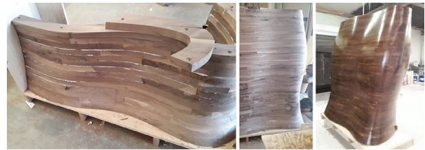
Fig. 3. Mock-Up sperimentale per l'indagine dei materiali e delle tecnologie che si utilizzeranno per la costruzione dell'elemento architettonico finale (fotografie di Devoto Design).
