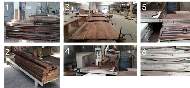
Fig. 6. Fasi per la produzione dei pannelli con i quali pantografare i tasselli lignei utilizzati per la costruzione di un modello fisico di forma complessa (fotografie di Devoto Design).
