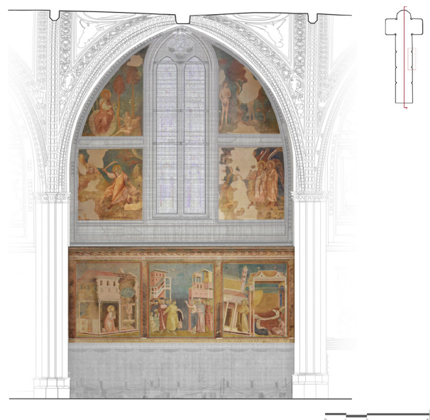
Fig. 2. Esempio di restituzione del rilievo digitale della Basilica Superiore di Assisi, ottenuto tramite laser scanner e integrato con dati fotogrammetrici, relativo ad una delle campate (elaborazione grafica di R. Ferretti).
