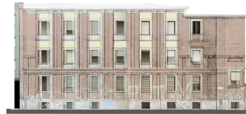
Fig. 9. Centrale telefonica di Città Studi, prospetto su via Spinoza. Sopra: progetto della sopraelevazione del 1962; sotto: sovrapposizione tra ortofoto e progetto del 1962 (elaborazione grafica degli autori).
