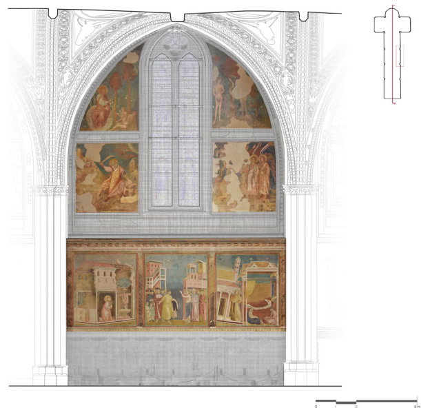
Fig. 2. Esempio di restituzione del rilievo digitale della Basilica Superiore di Assisi, ottenuto tramite laser scanner e integrato con dati fotogrammetrici, relativo ad una delle campate (elaborazione grafica di R. Ferretti).
