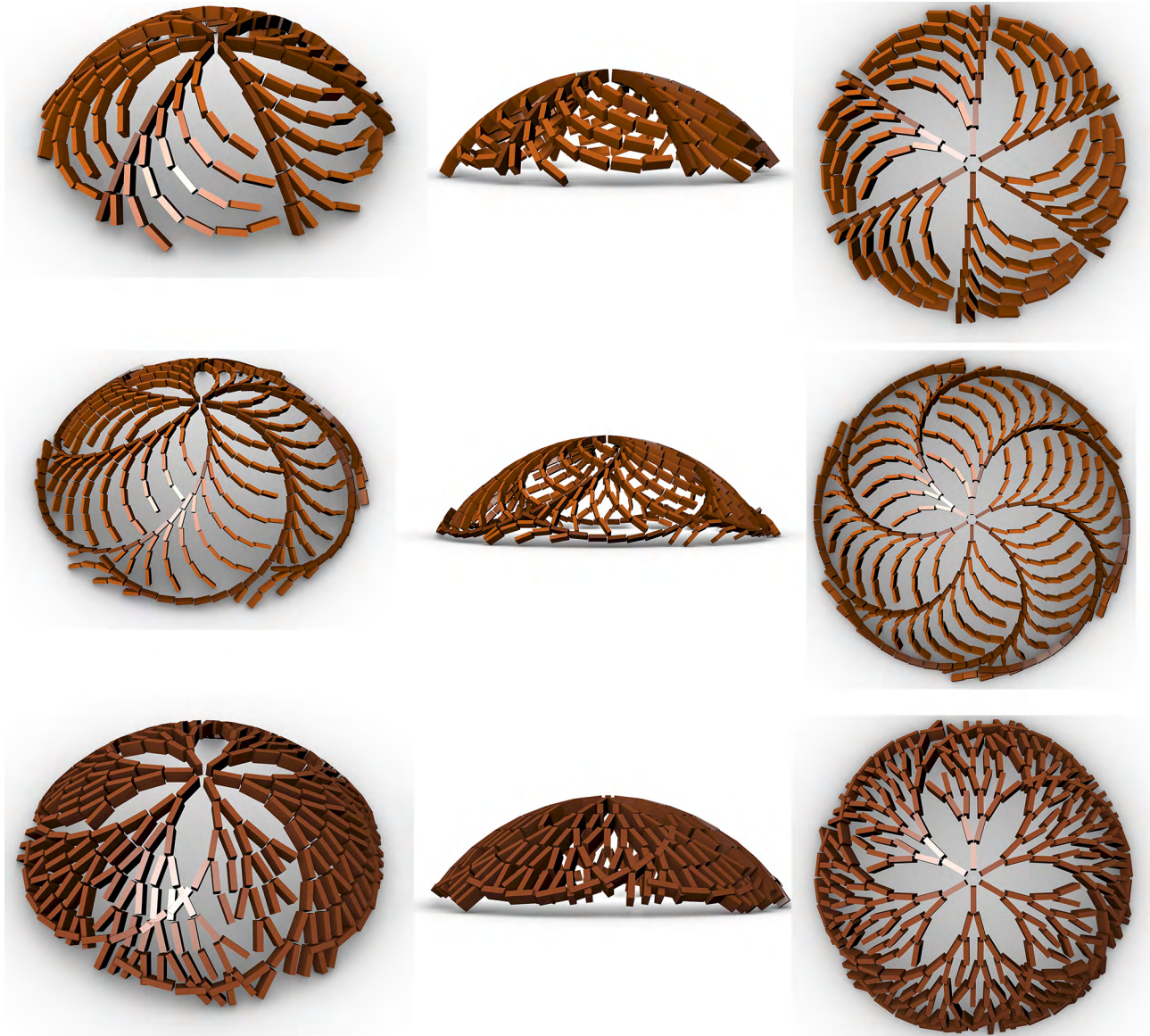
Fig. 6. Indagine computazionale sull'applicazione di modelli di crescita organica per la progettazione strutturale in architettura: trasposizione di schemi biomimetici per la realizzazione di cupole attraverso l'ottimizzazione formale e strutturale dell'uso del laterizio (elaborazione grafica degli autori).
