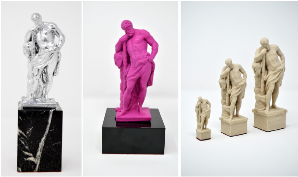
Fig. 5. I modelli analogici della statua di Ercole appartenente all'Università di Bologna ottenuti dai modelli digitali frutto di rilevamento fotogrammetrico con smartphone (fotografia di G. Bacci).
