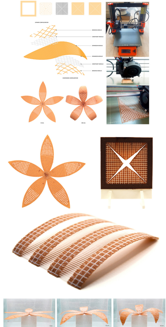
Fig. 12. Realizzazione e installazione degli attuatori lignei realizzati con stampa additiva per la verifica della igro-responsività e dei cinematismi (elaborazione grafica degli autori).
