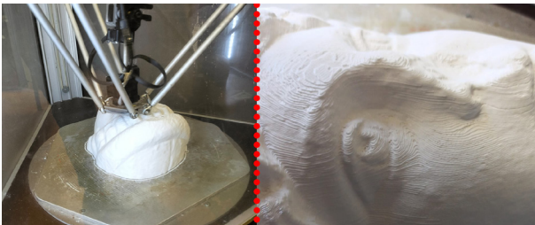
Fig. 4. La stampa 3D: a sinistra il processo di stampa; a destra il dettaglio della superficie con le scalettature tipiche del processo di produzione (fotografie dell'autore).
