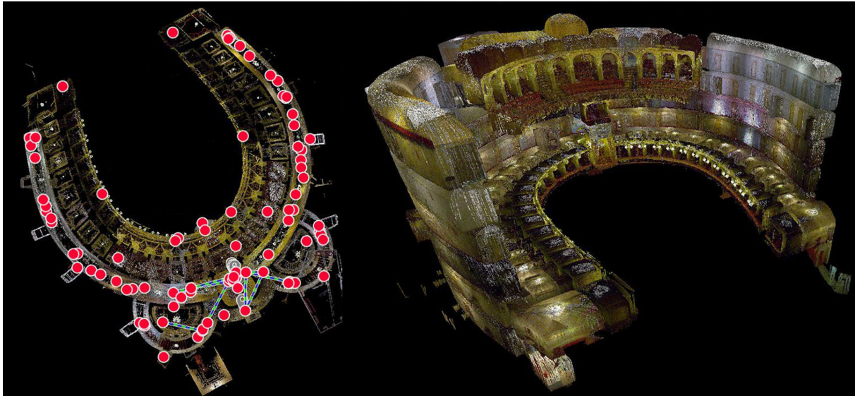
Fig. 5. Nuvola di punti del teatro massimo Bellini di Catania. A sinistra, progetto di ripresa del rilievo effettuato attraverso il laser scanner terrestre P30 della Leica Geosystem; a destra, vista prospettica della nuvola di punti della sala (elaborazione grafica degli autori).
