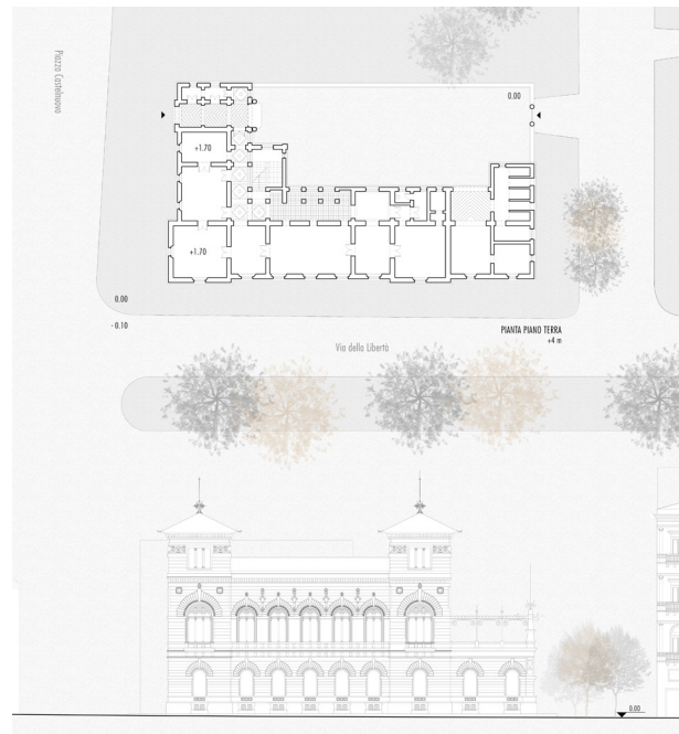
Fig. 8. Pianta e prospetto su via Libertà della quarta versione di progetto (elaborazione grafica di E. Luna).
