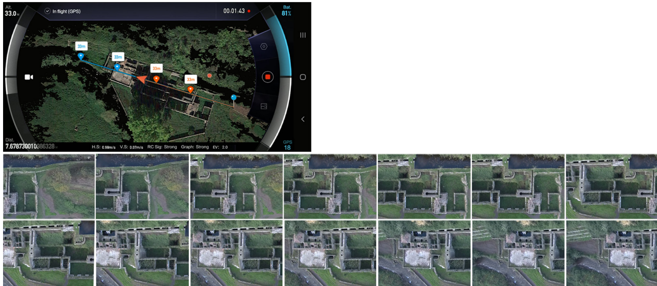
Fig. 8. Mission Planner Overview a direttrice longitudinale e angolo di presa fotografica zenitale, «Mulino-Ferriera Alviggi», (elaborazione grafica dell'autore).
