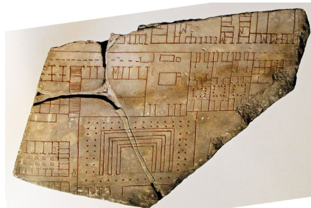
Fig. 4. Forma Urbis Romae , età severiana, frammenti I e, f, g, h [Docci, Maestri 1993, fig. 30, p. 25]. Sulla destra sono visibili tre domus e un odeon con al centro indicati i sedili e il colonnato di sostegno del tetto.
