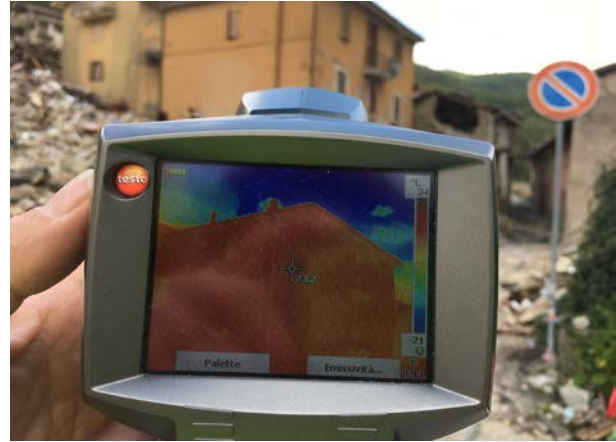
Fig. 3. Acquisizione con termocamera.
