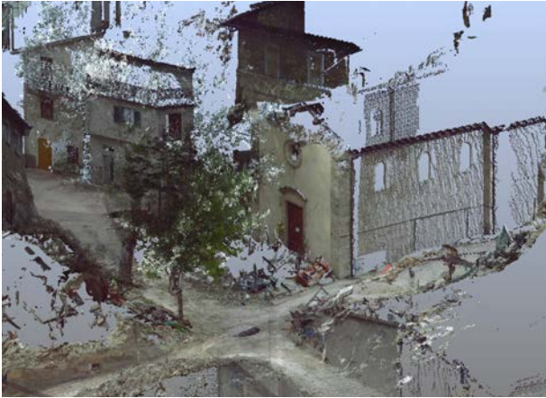
Fig. 2. Acquisizione della frazione di Grisciano con Laser Scanner Faro Focus 3D (elaborazione di Leonardo Paris).
